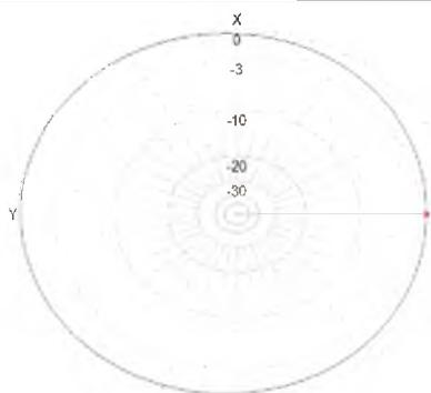
Рисунок 8 – ДН для ввода  $h_2$  с учетом подсоединения к ЛЭП
