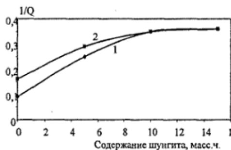
Рисунок 3 – Влияние содержания шунгита на степень сшивания ПХ (Байпреп 330): 1 – T = 155^\circ\text{C} ; 2 – T = 170^\circ\text{C} ( t = 30 мин)
