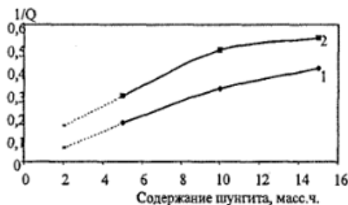
Рисунок 5 – Влияние содержания шунгита на степень сшивания ХСПЭ: 1 – T = 155^\circ\text{C} ; 2 – T = 170^\circ\text{C} ( t = 30 мин)
