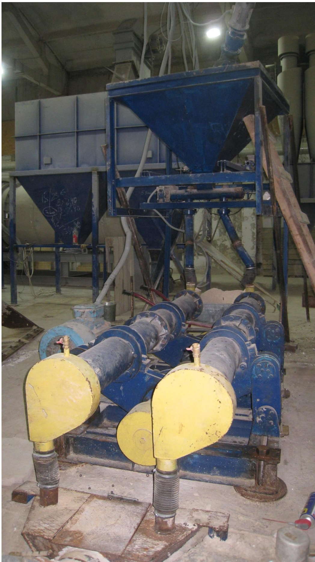
Фото автора 3336. Виброцентробежная мельница производительностью 1 т/ч
