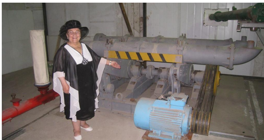
Фото автора 48. Виброцентробежная мельница производительностью 5 т/ч
