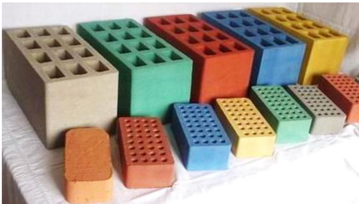
Рис. 1 Порошковая окраска силикатных бетонных блоков и кирпичей
