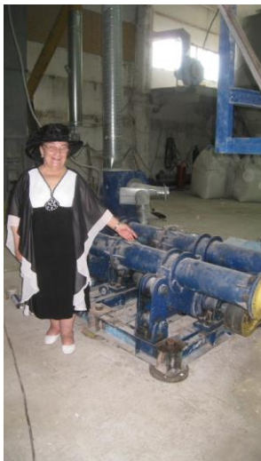
Рис. 2. Планетарная шаровая мельница-активатор.
