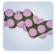
Полиэтилен линейной структуры, изготовленный методом низкого давления, с очень высокой степенью полимеризации – молекулярная масса более 1,5 млн, обладает особой комбинацией свойств, позволяющей применять его там, где низкомолекулярные полиэтилены полимеры И многие другие выдерживают жестких условий эксплуатации.
